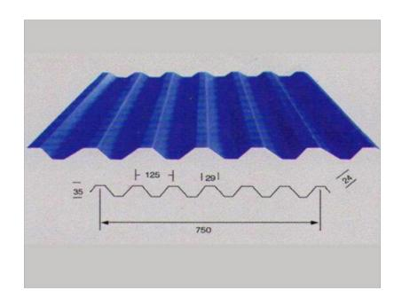
彩钢板的特点□A.□彩钢板均可拆卸再复原,可方便进行组装拆卸,标准单元墙板均可互换,对维护水电,线路改造等非常便捷□B□彩钢板板面可以任意开孔,对安装控制开关、电源插座等装置非常方便,不需另外处理□C□彩钢板表面颜色柔和,与地板、天花构成统一和谐的整体,使整个空间具有现代气息□D□采用静电烤漆喷涂工艺,表面平滑、细腻,不积尘,保养简单,极大的保证了机房的洁净度要求□E□彩钢板符合国标A级防火标准,能充分满足机房建设装修的防火要求。横向穿心龙骨:增高超过3米以上,以垂直方向1.2米置一支,当连两支衔接处必须重叠,重叠长度不得少于10cm□
